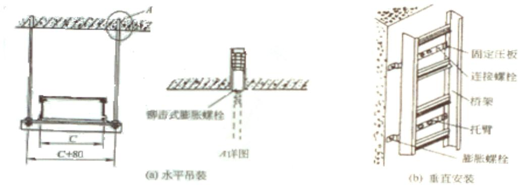
图 3.4.2.1 电缆桥架安装示意图
